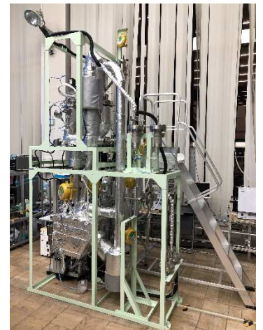
バイオマスガス化システムデモ機
